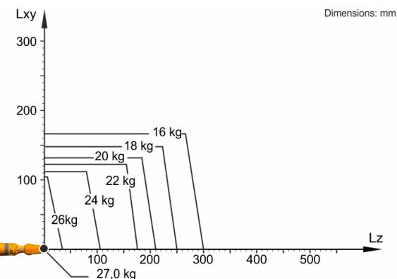
KR 22 R1610 设计用于 22 kg 的额定负载能力，以便最佳利用机器人的性能和动态性。在负载间隔缩小且具有合适的附加负载情况下，可以施加多达 27 kg 的最大负载。特殊的负载实例必须用 KUKA Load 进行检查。如果需要详细咨询，请联系 KUKA 售后服务部。
