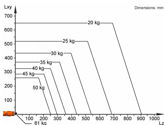
KR 50 R2100 CR lite 设计用于 50 kg 的额定负载，以便最佳利用机器人的性能和动态性。在负载间隔缩小且具有合适的附加负载情况下，可以施加多达 61 kg 的最大负载。特殊的负载实例必须用 KUKA Load 进行检查。如果需要详细咨询，请联系 KUKA 服务部门。
